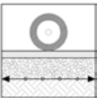
Rinforzare, aumentare l'idoneità a sopportare il traffico veicolare riducendo gli spessori della fondazione
