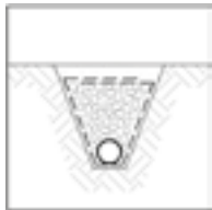
Drenaggio delle acque di infiltrazione
