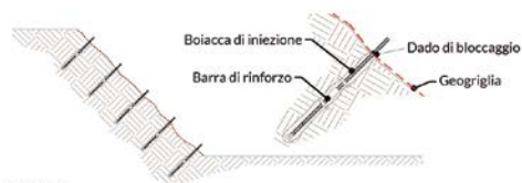
2° PASSO - Posa della geogriglia. - Fissaggio della geogriglia al terreno tramite dadi di bloccaggio.
