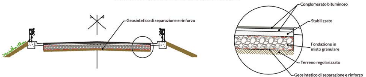
RINFORZO DEL TERRENO DI IMPOSTA DEI CASSONETTI STRADALI
