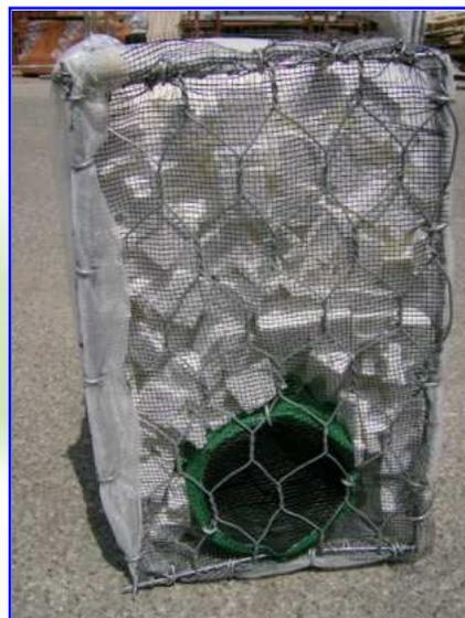
GEOTESSILE DI RIVESTIMENTO
