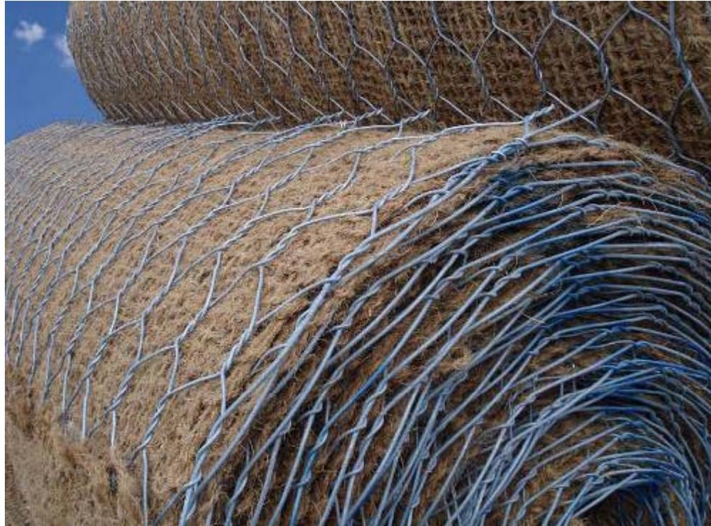
*Il sistema R.E.C.S.<sup>®</sup> (Reinforced Erosion Control System) consiste in una gamma di geocompositi precoppiati in fase di produzione per la realizzazione di opere di protezione, conservazione e rinverdimento del suolo. I geocompositi sono costituiti da rete metallica a doppia torsione accoppiata in fase di produzione con bioreti naturali in agave o cocco oppure geotessuti metallici o polimerici.*
