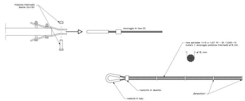
PARTICOLARE CONNESSIONE AL PUNTO DI ANCORAGGIO
